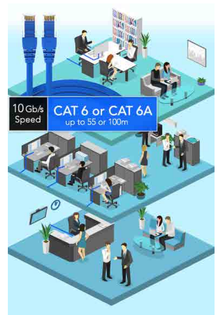
コンピュータとスイッチ 或いはデバイスの10 GbE ポートに 廉価なCat 6、Cat 6A 銅ケーブルで接続
